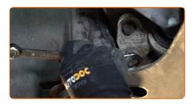
Legen Sie das Kugelgelenk in die Achsschenkel und fixieren Sie es mit einer neuen Mutter.
