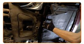
Schrauben Sie die Verbindungselemente der Schalleindrucksdämmung ein. Verwenden Sie einen Kreuzschlitzschraubendreher.
