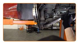
Trennen Sie das Kugelgelenk vom Achsschenkel. Verwenden Sie einen Kugelgelenkabzieher.
