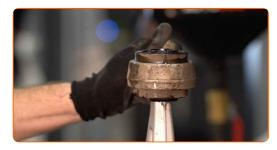
Lockern Sie den Schraubstock und entfernen Sie den Querlenker.
