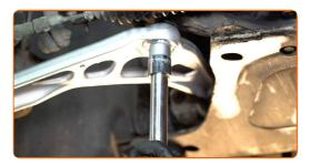
Spannen Sie die Armbefestigung an das Untergestell. Verwenden Sie Ring-Gabelschlüssel Nr. 21. Verwenden Sie einen Drehmomentschlüssel. Ziehen Sie ihn mit 90 Nm Drehmoment fest.
