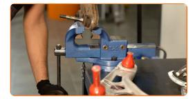
Greifen Sie den neuen Querlenker in einem Schraubstock.
