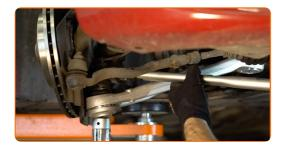
Ziehen Sie das hintere Befestigungselement des Querlenkers an. Verwenden Sie Stecknuss Nr. 18. Verwenden Sie Ring-Gabelschlüssel Nr. 18. Verwenden Sie einen Drehmomentschlüssel. Ziehen Sie ihn mit 59 Nm Drehmoment fest.
