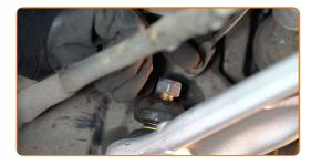
Entfernen Sie den Träger unter dem Achsschenkel.
