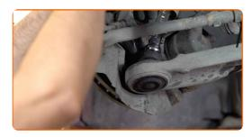
Lösen Sie das Befestigungselement, das den Fahrzeug-Niveausensor mit dem Aufhängungs-Querlenker verbindet. Verwenden Sie Stecknuss Nr. 13. Verwenden Sie einen Ratschenschlüssel.
