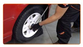
Entfernen Sie den Wagenheber sowie die Unterlegkeile.
