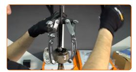
Lockern Sie den Schraubstock und entfernen Sie den Querlenker.
