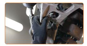
Schrauben Sie die Armbefestigung aus dem Untergestell heraus. Verwenden Sie Ring-Gabelschlüssel Nr. 21.
