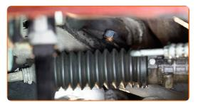
Schrauben Sie das Befestigungselement ein, das den Querlenker mit dem Hilfsrahmen verbindet. Verwenden Sie Ring-Gabelschlüssel Nr. 21.
