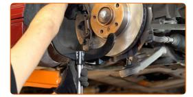
Entfernen Sie den Arm. Benutzen Sie ein Brecheisen.
