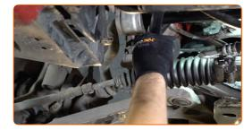
Lösen Sie die hintere Armbefestigung. Verwenden Sie Stecknuss Nr. 18. Verwenden Sie Ring-Gabelschlüssel Nr. 18. Verwenden Sie einen Ratschenschlüssel.
