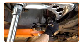
Entfernen Sie den Träger unter dem Arm.
