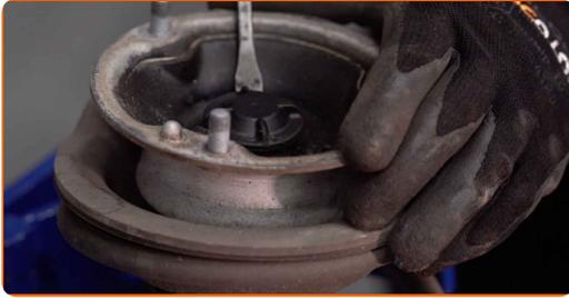
23 Entfernen Sie die Stangenmutter des Federkolben. Verwenden Sie Stecknuss Nr. 22. Verwenden Sie Inbusschlüssel Nr. H7.
