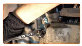
Verbinden Sie den Schlauch des Bremsentlüftungs-Kits mit der Bremsentlüftungsschraube.
