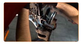
Befestigen Sie den Bremsschlauch an der Strebe.
