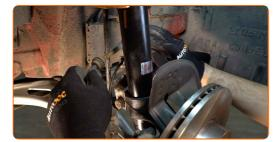
Schrauben Sie das Befestigungselement heraus, das den Bremsschlauch mit der Bremskreisleitung verbindet. Verwenden Sie Ring-Gabelschlüssel Nr. 10.
