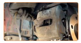
Drücken Sie mehrere Male auf das Bremspedal, um jegliche Luft aus dem System entweichen zu lassen.
