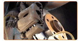
Trennen Sie den Schlauch des Bremsentlüftungs-Kits.
