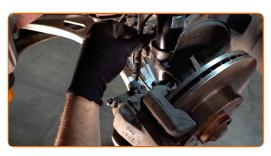
Schrauben Sie den neuen Bremsschlauch auf den Bremssattel.
