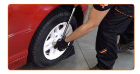
Entfernen Sie den Wagenheber sowie die Unterlegkeile.
