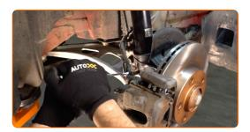
Lösen Sie den Bremsschlauch vom Federbein.
