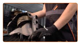
Schrauben Sie das Befestigungselement des Luftmassenmessers heraus. Entfernen Sie das Teil. Verwenden Sie Stecknuss Nr. 10. Verwenden Sie einen Ratschenschlüssel.
