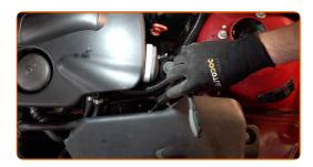
Schrauben Sie die Filtergehäuse-Befestigungsbolzen ab. Verwenden Sie Stecknuss Nr. 10.
