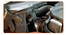
Lösen Sie die Befestigungsschrauben der Luftfilter-Abdeckung. Verwenden Sie einen Kreuzschlitzschraubendreher.
