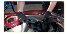
Sichern Sie den Ansaugluftschlauch. Schrauben Sie die Befestigungsklemme ein, die das Luftkanal-Gehäuse mit dem Luftfilter-Gehäuse verbindet. Verwenden Sie Stecknuss Nr. 8.
