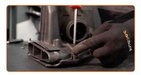
Bringen Sie das Luftfiltergehäuse wieder an. Schließen Sie den Luftmassenmesser an.
