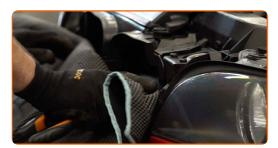
Entfernen Sie die Befestigungen des Luftkanal-Gehäuses. Trennen Sie das Luftkanal-Gehäuse vom Luftfilter-Gehäuse.
