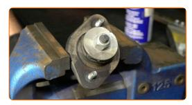
Reinigen Sie die Befestigungen vom Stoßdämpferschaft. Benutzen Sie eine Drahtbürste. Benutzen Sie WD-40-Spray.
