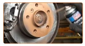
Die Bremsscheibenoberfläche reinigen. Benutzen Sie einen Bremsenreiniger.
