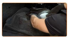
Bringen Sie die Clips der Seitenauskleidung des Kofferraums an.
