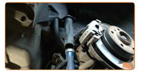
Reinigen Sie die Stoßdämpferaufnahmen. Benutzen Sie eine Drahtbürste. Benutzen Sie WD-40-Spray.
