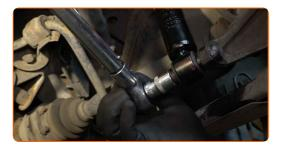
Entfernen Sie den Träger unter dem Arm.
