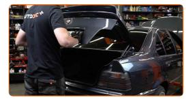
Entfernen Sie die Clips der Seitenauskleidung des Kofferraums. Verwenden Sie einen Lösehebel, um die Clips zu entfernen.
