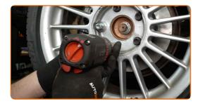
Senken Sie das Auto und ziehen Sie die Radschrauben über Kreuz an. Verwenden Sie eine Schlagnuss für Felgen # 17. Verwenden Sie einen Drehmomentschlüssel. Ziehen Sie ihn mit 120 Nm Drehmoment fest.
