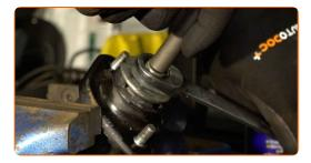
Entfernen Sie den oberen Halter des Stoßdämpfers.
