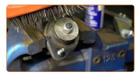
Entfernen Sie die Befestigung der Stoßdämpferkolbenstange. Verwenden Sie einen Stoßdämpfer Steckschlüsseleinsatz DDNº6. Verwenden Sie Stecknuss Nr. 16. Verwenden Sie einen Ratschenschlüssel.
