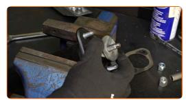
Ziehen Sie die Mutter der Stoßdämpferkolbenstange fest. Verwenden Sie Stecknuss Nr. 16. Verwenden Sie einen Stoßdämpfer Steckschlüsseleinsatz DDNº6 Verwenden Sie einen Drehmomentschlüssel. Ziehen Sie ihn mit 37 Nm Drehmoment fest.
