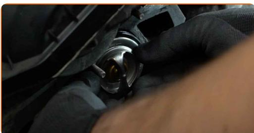
**22** Behandeln Sie den Montagesitz des Thermostatgehäuses. Verwenden Sie ein Dichtmittel.
