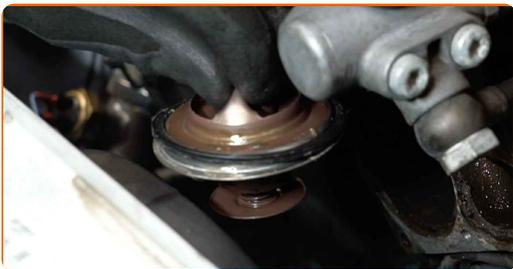
**20** Reinigen Sie den Montagesitz des Thermostatgehäuses. Verwenden Sie einen flachen Schraubendreher. Verwenden Sie einen Dichtungsschaber. Verwenden Sie Allzweckreinigungsspray.
