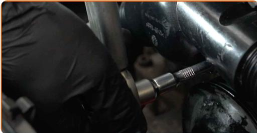
**25** Bringen Sie die Halterung der Kühlmittleitung an. Verwenden Sie Stecknuss Nr. 13. Verwenden Sie einen Drehmomentschlüssel. Ziehen Sie ihn mit 11 Nm Drehmoment fest.
