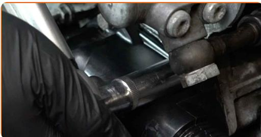
**26** Ziehen Sie die Befestigungselemente des Thermostatgehäuses fest. Verwenden Sie Stecknuss Nr. 10. Verwenden Sie einen Drehmomentschlüssel. Ziehen Sie ihn mit 7 Nm Drehmoment fest.
