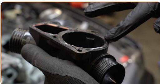
**23** Installieren Sie das neue Thermostatgehäuse.
