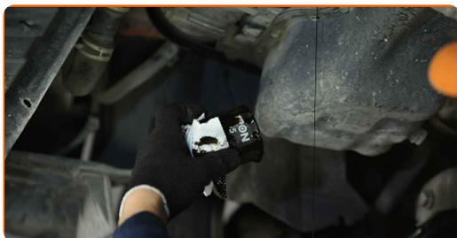
**10** Reinigen Sie die Ölfilteraufnahme.
