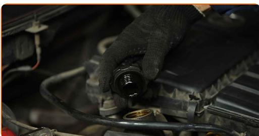
**21** Befestigen Sie den Deckel des Öleinfüllstutzens.
