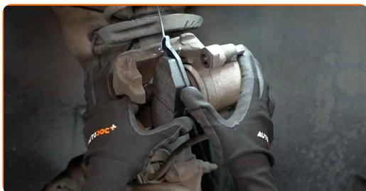
**Austausch: Bremsbeläge – VW Caddy 3 Kasten. AUTODOC-Experten empfehlen:**
