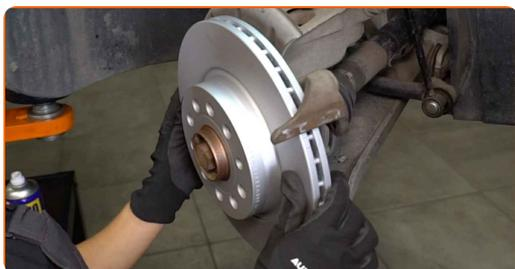
**18** Ziehen Sie die Befestigung der Bremsscheibe fest. Verwenden Sie den Torx T30. Verwenden Sie einen Drehmomentschlüssel. Ziehen Sie ihn mit 9 Nm Drehmoment fest.
