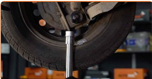
**13** Schrauben Sie den unteren Befestiger des Stoßdämpfers ab. Verwenden Sie Stecknuss Nr. 18.
