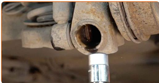
**11** Die Montage unter dem Hinterachsträger entfernen.
