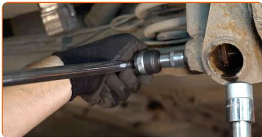
**9** Entfernen Sie die Befestigungsschraube.
