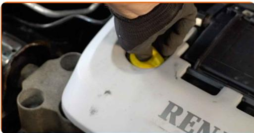
**31** Lassen Sie den Motor ein paar Minuten laufen. Nachdem die Ölstands-Warnleuchte erloschen ist, stoppen Sie den Motor.
