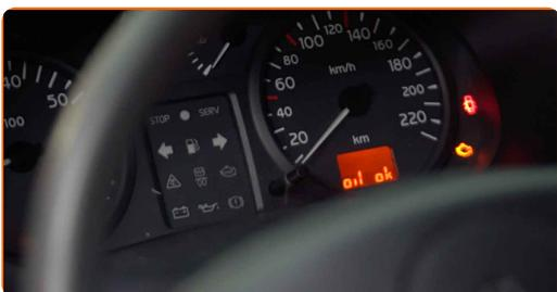
**32** Überprüfen Sie den Ölstand 5 Minuten nach dem Anhalten des Motors, verwenden Sie einen Peilstab und fügen Sie - wenn nötig - Öl hinzu.
