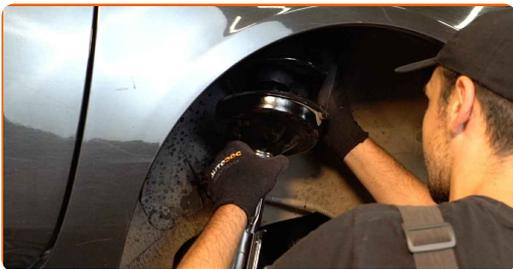
**35** Schrauben Sie die obere Befestigung des Domlagers an. Schrauben Sie diese nicht fest.
