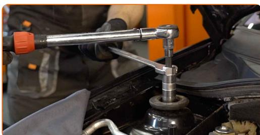
**50** Behandeln Sie die Befestigungselemente des Federbeinstützlagers. Benutzen Sie ein Kupferschmiermittel.
