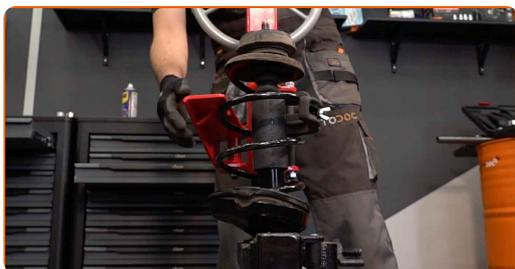
**33** Entfernen Sie das zusammengebaute Federbein.
