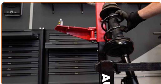
**34** Installieren Sie das Federbein am Radlauf.
