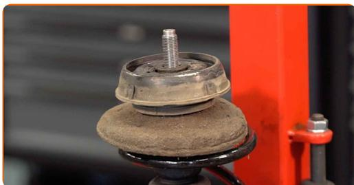
**31** Ziehen Sie die Federbeinkolbenstangenmutter an. Verwenden Sie Stecknuss Nr. 17. Verwenden Sie Inbusschlüssel Nr. H6. Verwenden Sie einen Drehmomentschlüssel. Ziehen Sie ihn mit 21 Nm Drehmoment fest.
