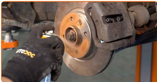
**13** Die Bremsscheibenoberfläche reinigen. Benutzen Sie einen Bremsenreiniger.
