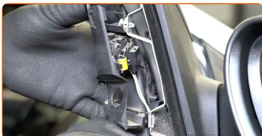
**16** Schrauben Sie die Befestigungen der Schutzabdeckung des Außenspiegels ein. Verwenden Sie den Torx T25.
