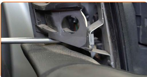
**6** Lösen Sie die Dreiecksblende des Außenspiegels. Verwenden Sie einen Zierleistenkeil.
