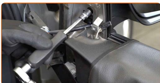
**13** Schließen Sie den Steckverbinder des Spiegelverstellers an der Tür wieder an.
