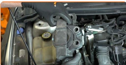
**Austausch: Motorlager – Ford Focus MK2. Tipp von AUTODOC:**
