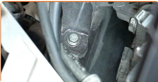
**8** Schrauben Sie die Befestigungen, die das Motorlager mit der Karosserie verbinden, ab. Verwenden Sie Stecknuss Nr. 18. Verwenden Sie einen Ratschenschlüssel.
