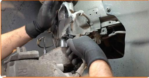
**61** Reinigen Sie die Montagesitze der Koppelstange. Benutzen Sie eine Drahtbürste. Benutzen Sie WD-40-Spray.
