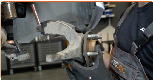
**35** Reinigen Sie das Befestigungselement der Radnabe. Benutzen Sie eine Drahtbürste. Benutzen Sie WD-40-Spray.
