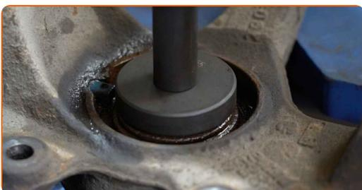
**37** Reinigen Sie den Befestigungssitz der Radnabe. Benutzen Sie eine Drahtbürste. Benutzen Sie WD-40-Spray.
