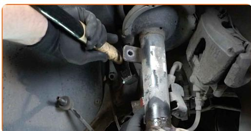
**34** Entfernen Sie die Achsschenkel zusammen mit der Nabe.
