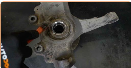
**36** Entfernen Sie die Nabe und das Lager zusammen, da sie eine versiegelte Einheit sind. Verwenden Sie einen Druckstücksatz mit Ein-/Auspresswerkzeug.
