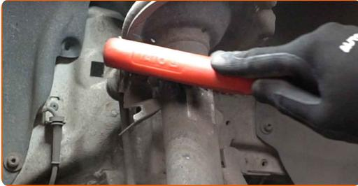
**9** Schrauben Sie das Befestigungselement heraus, das die Druckstange mit dem Federbein verbindet. Verwenden Sie Stecknuss Nr. 17. Verwenden Sie einen Ratschenschlüssel.
