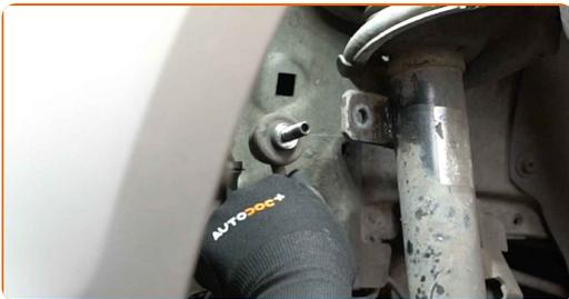
**11** Reinigen Sie das Befestigungselement der Antriebswelle. Benutzen Sie eine Drahtbürste. Benutzen Sie WD-40-Spray.
