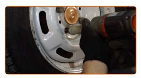
Senken Sie das Auto und ziehen Sie die Radschrauben über Kreuz an. Verwenden Sie einen Drehmomentschlüssel. Ziehen Sie ihn mit 90 Nm Drehmoment fest.
