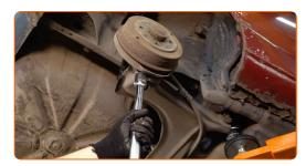
Ziehen Sie die untere Befestigung des Stoßdämpfers an. Verwenden Sie Stecknuss Nr. 18. Verwenden Sie einen Drehmomentschlüssel. Ziehen Sie ihn mit 95 Nm Drehmoment fest.
