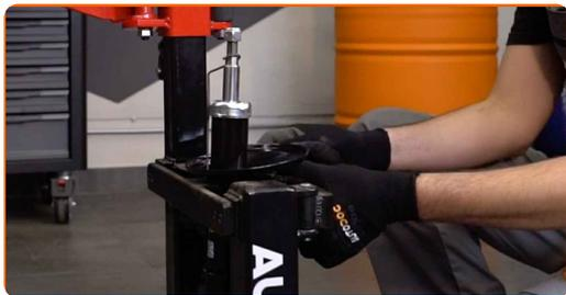
**28** Installieren Sie die Staubschutzmanschette und den Anschlagpuffer auf dem neuen Stoßdämpfer.
