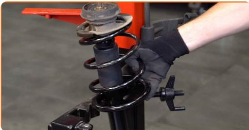
**35** Installieren Sie das Federbein am Radlauf.
