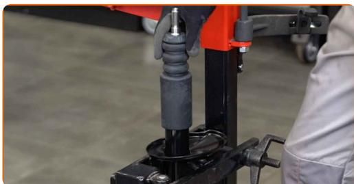
**29** Installieren Sie die Feder am Stoßdämpfer.
