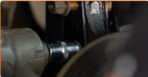
**42** Ziehen Sie die unteren Befestigungen an, die das Federbein mit dem Achsschenkel verbinden. Verwenden Sie Ring-Gabelschlüssel Nr. 18. Verwenden Sie Stecknuss Nr. 18. Verwenden Sie einen Drehmomentschlüssel. Ziehen Sie ihn mit 110 Nm Drehmoment fest.
