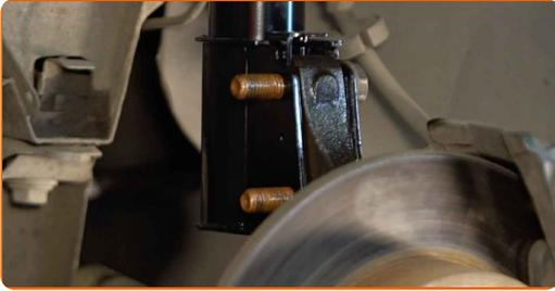
**40** Entfernen Sie den Träger unter dem Achsschenkel.
