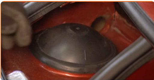
**52** Entfernen Sie die Kotflügel-Abdeckung.
