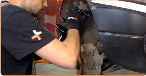
**36** Schrauben Sie die obere Befestigung des Domlagers an. Schrauben Sie diese nicht fest.
