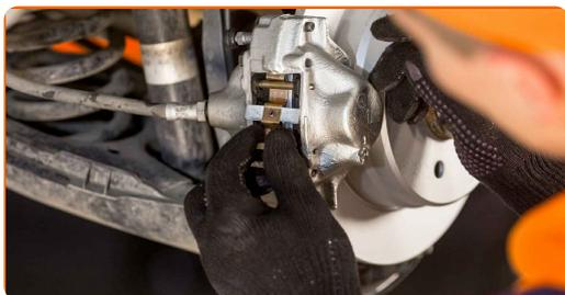
**22** Bringen Sie die Halteclips der Bremsbeläge an. Verwenden Sie einen Splintentreiber. Benutzen Sie einen Hammer. Benutzen Sie ein Brecheisen.
