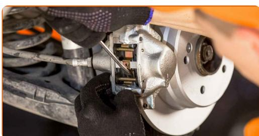
**23** Ziehen Sie das Befestigungselement an, das die Bremsleitung mit dem Bremssattel verbindet. Verwenden Sie einen offenen Ringschlüssel #14. Verwenden Sie einen Drehmomentschlüssel. Ziehen Sie ihn mit 18 Nm Drehmoment fest.
