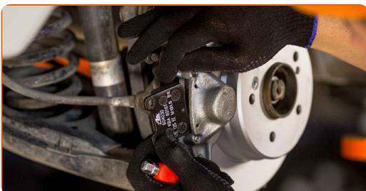
**11** Klemmen Sie den Bremsschlauch ab, indem Sie eine geeignete Klemme einsetzen.
