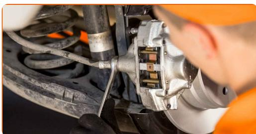
**24** Entfernen Sie die Klammer des Bremsschlauchs.
