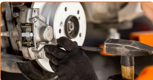
**8** Entfernen Sie die Rückholfeder der Bremsbeläge.
