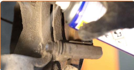
**12** Lösen Sie die Befestigung der Sattelhalterung. Verwenden Sie Stecknuss Nr. E12. Verwenden Sie ein Windeisen.
