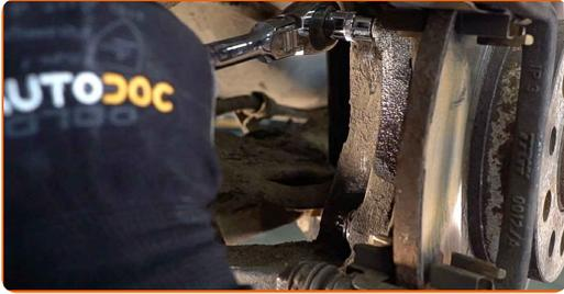
**13** Entfernen Sie die Sattelhalterung.
