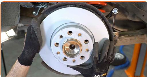
**19** Ziehen Sie die Befestigung der Bremsscheibe fest. Verwenden Sie Inbusschlüssel Nr. H5. Verwenden Sie einen Drehmomentschlüssel. Ziehen Sie ihn mit 7 Nm Drehmoment fest.
