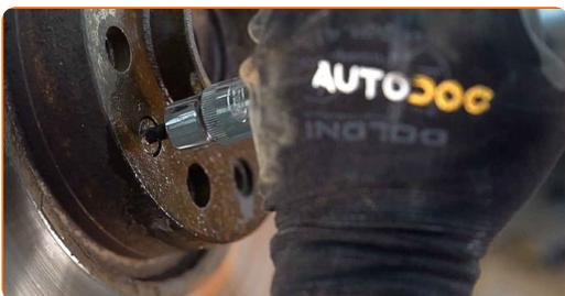
**16** Entfernen Sie die Bremsscheibe.
