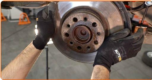
**17** Behandeln Sie die Radnabe an der Kontaktstelle mit der Bremsscheibe. Benutzen Sie ein Kupferschmiermittel.
