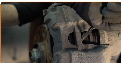
**10** Die Bremssattelbefestigungen reinigen. Benutzen Sie eine Drahtbürste. Benutzen Sie WD-40-Spray.
