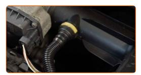
Montieren Sie die Kurbelgehäuse-Entlüftungsschläuche.
