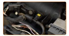
Verbinden Sie den Kurbelgehäuse-Entlüftungsschlauch mit dem Ansaugkrümmer.
