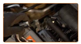
Decken Sie das PCV-Ventilloch mit einem Mikrofasertuch ab, um zu verhindern, dass Schmutz und Fremdkörper in das System gelangen.
