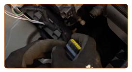
Ziehen Sie den Anschluss der Zündspule ab.
