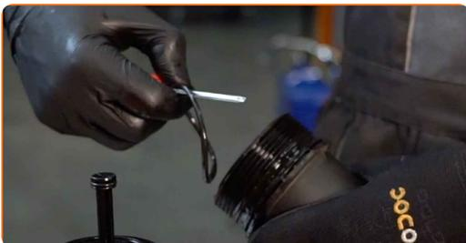
**13** Installieren Sie einen neuen Dichtungsring an seinem Montagesitz auf der Filterabdeckung.
