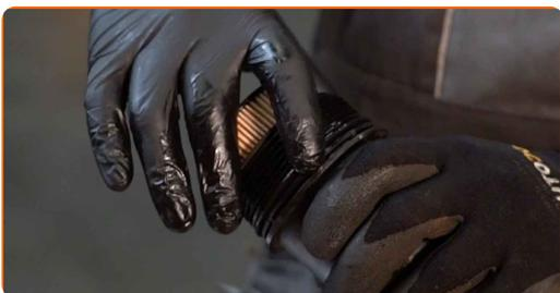
**15** Setzen Sie den neuen Ölfilter in den Montagesitz auf der Filterabdeckung ein.
