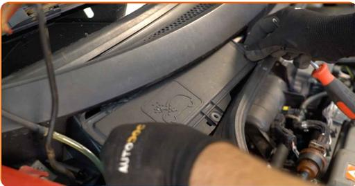
**8** Schrauben Sie die Verbindungselemente der Innenfilter-Gehäuseabdeckung ein. Verwenden Sie einen Kreuzschlitzschraubendreher.
