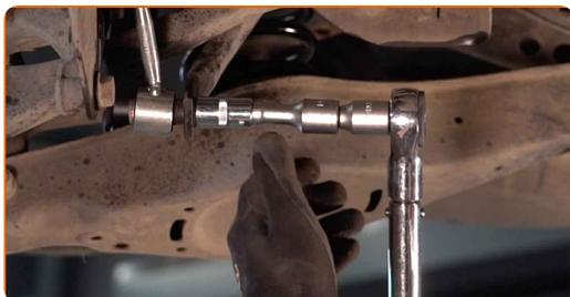
**13** Ziehen Sie das Befestigungselement an, das den Stabilisator mit dem Querlenker verbindet. Verwenden Sie Ring-Gabelschlüssel Nr. 16. Benutzen Sie den XZN #6. Verwenden Sie einen Drehmomentschlüssel. Ziehen Sie ihn mit 45 Nm Drehmoment fest.
