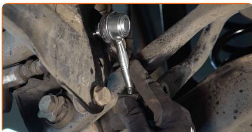
**12** Ziehen Sie das Befestigungselement an, das die Druckstange mit dem Stabilisator verbindet. Verwenden Sie Ring-Gabelschlüssel Nr. 16. Benutzen Sie den XZN #6. Verwenden Sie einen Drehmomentschlüssel. Ziehen Sie ihn mit 45 Nm Drehmoment fest.
