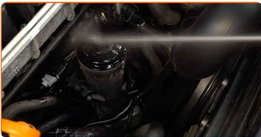
**5** Schrauben Sie den Filtergehäusedeckel zusammen mit dem alten Filterelement ab. Verwenden Sie Stecknuss Nr. 32. Verwenden Sie einen Ratschenschlüssel.
