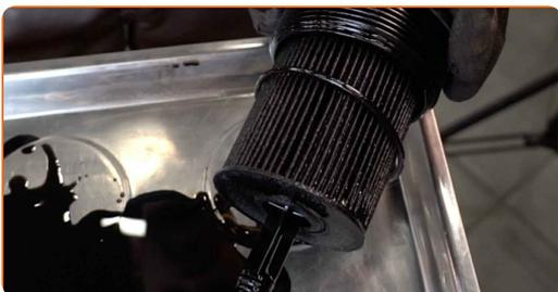
**22** Lösen Sie den Ölfilter vom Filterdeckel.
