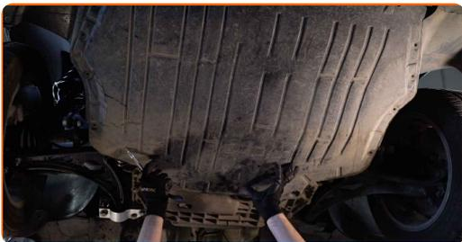
**19** Ziehen Sie die Befestigungen der unteren Ölwanne-Abdeckung fest. Verwenden Sie den Torx T25. Verwenden Sie einen Ratschenschlüssel.
