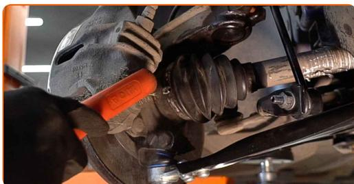
**10** Schrauben Sie die Befestigung des Bremssattels ab. Verwenden Sie Ring-Gabelschlüssel Nr. 13.
