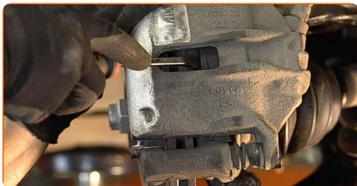
**12** Entfernen Sie den Bremssattel.
