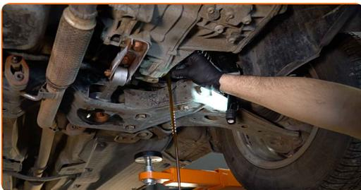
Austausch: Schaltgetriebeöl – Skoda Fabia 6Y5. AUTODOC-Experten empfehlen:
