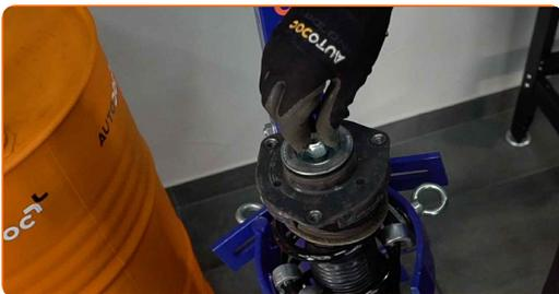
41 Ziehen Sie die Federbeinkolbenstangenmutter an. Verwenden Sie Ring-Gabelschlüssel Nr. 21. Verwenden Sie Inbusschlüssel Nr. H7. Verwenden Sie einen Drehmomentschlüssel. Ziehen Sie ihn mit 60 Nm Drehmoment fest.
