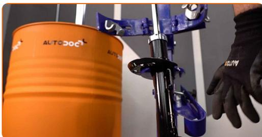
37 Installieren Sie die Staubschutzmanschette und den Anschlagpuffer auf dem neuen Stoßdämpfer.
