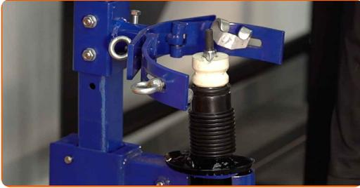
38 Installieren Sie die Feder am Stoßdämpfer.
