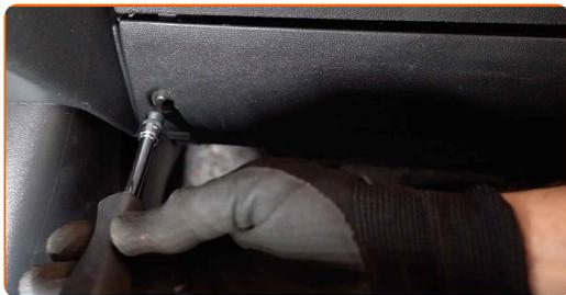
**4** Heben Sie ihn an, lösen Sie ihn von den Verbindungselementen und entfernen Sie die Seitenverkleidung an der Beifahrerseite.
