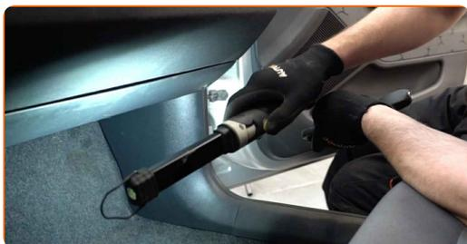
**3** Lösen sie die Befestigungsschrauben des Handschuhfaches ab. Verwenden Sie den Torx T20.
